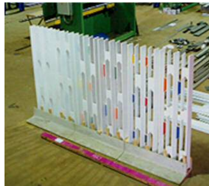
Figura 13. Foto do primeiro protótipo do elemento, muro vazado e base do muro que apoia o elemento vazado
