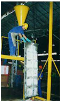
Figura 9. Produção de divisórias em formas
