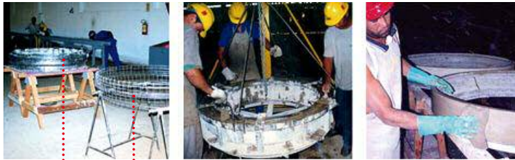
FORMA METÁLICA ARMAÇÃO ARGAMASSA ACABAMENTO
