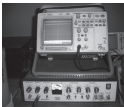
Figura 1. Equipo generador de pulso ultrasónico y osciloscopio (A). Transductores de contacto y gel de acople (B)
