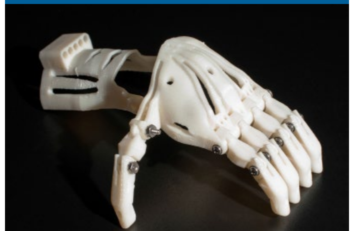
Figura 4. Mano protésica impresa en 3D Fuente: https://www.flickr.com/photos/fdaphoos/18306292659
