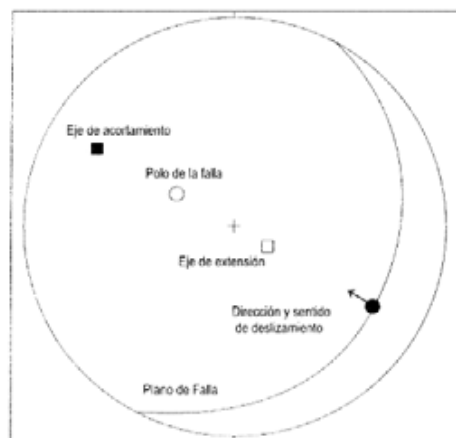
FIG. 6. Geometría de la cinemática de desplazamiento de una falla en proyección equiareal en el hemisferio inferior (modificado de Marrett y Allmendinger, 1990).
