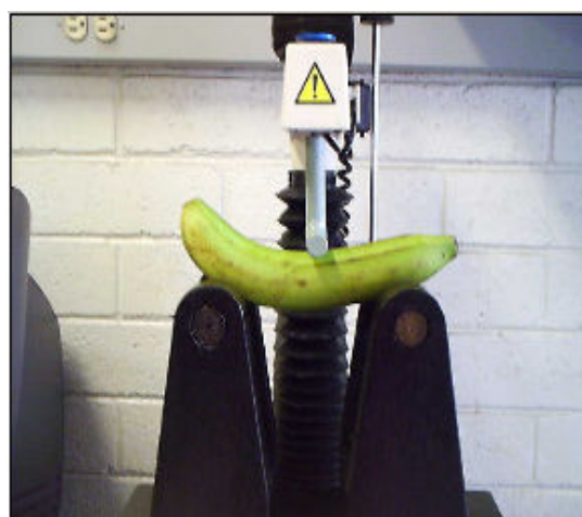
Figura 6. Prueba de fractura a compresión y flexión en banano var. Cavendish Valery.
