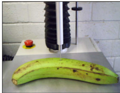
Figura 1. Prueba de firmeza por compresión unidereccional en banano var. Cavendish Valery.
