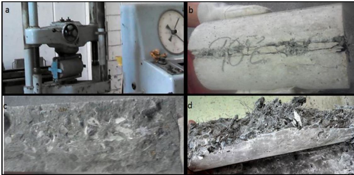
Figura 3. Ensayo brasileño y las diferentes formas de rotura
