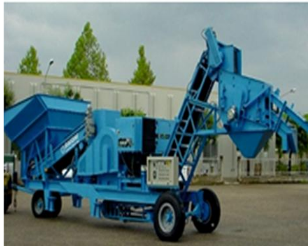
Fig.3. Planta móvil secundaria, serie CANGURO GMS. Fuente: Baioni, 2012.
