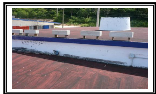
Figura 2 a) Ubicación de la unidad de muestreo en el Centro Regional de Investigaciones Pesqueras (CRIP), en San Francisco de Campeche, México. b) Unidad de exposición de vigas de concreto en el CRIP.
