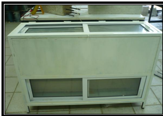
Figura 3 Cámara de carbonatación acelerada.
