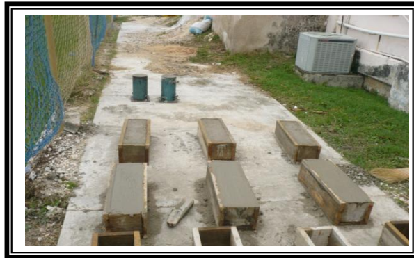
Figura 1 Elaboración de vigas de concreto simple.
