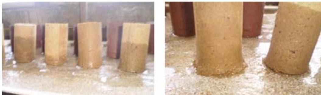
Figura 10. Ensayo de ascensión capilar.
