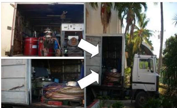
Figura 3.a, b, c. Camión equipado con sistema de proyección y depósitos con las materias primas. Fotos de las autoras.
