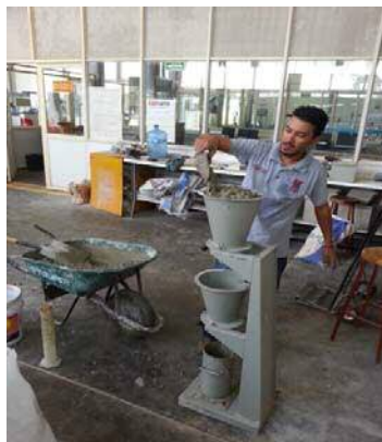
Foto 2. Llenado de la tolva superior para la prueba de factor de compactación.
