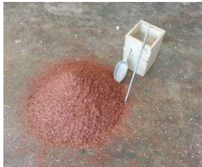
Foto 1: Preparando la Cáscara de nuez para peso volumétrico suelto y compacto (PVS Y PVC)
