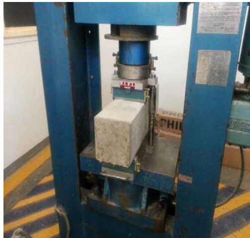
Foto 3.- Prueba a Flexión con agregado Cáscara de Nuez y Humo de Sílice, con diferentes porcentajes
