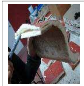
Figura 8. Sustrato de asbesto cemento
