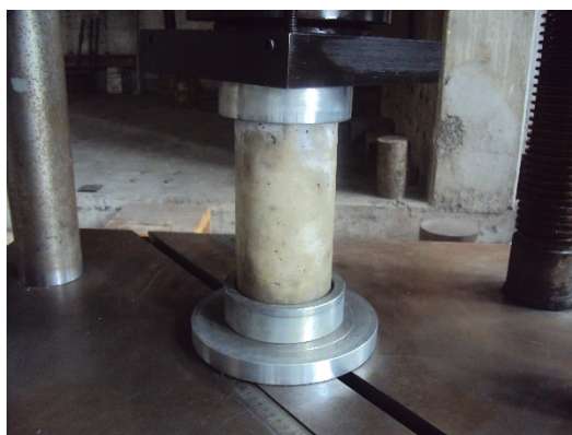
Fotografía 11. Probeta cilíndrica M-R en prensa universal antes de recibir carga.
