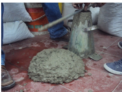
Fotografía 4. Mezcla M-R; ensayo de asentamiento.
