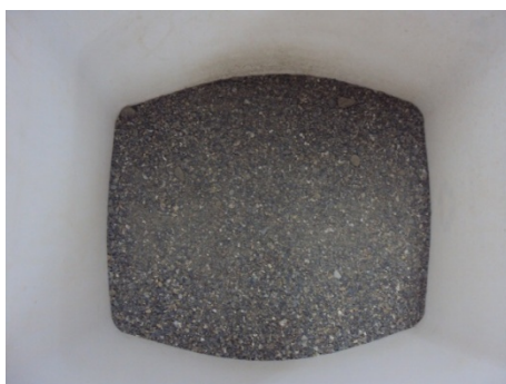
Fotografía 2. Agregado fino de cantera.
