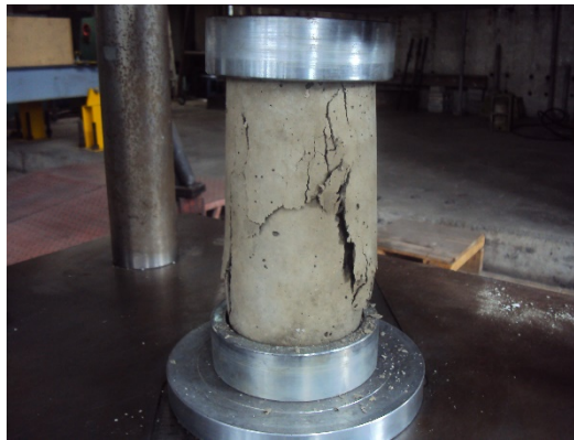
Fotografía 12. Probeta cilíndrica M-R luego de aplicación de carga.
