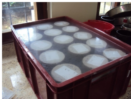
Fotografía 10. Probetas cilíndricas en tanques de curado.
