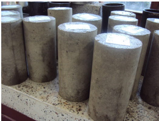
Fotografías 8 y 9. Aspecto físico de las probetas desencofradas para llevar a tanque de curado.
