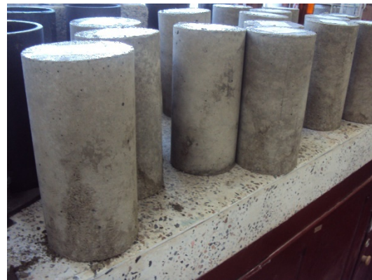
Fotografías 8 y 9. Aspecto físico de las probetas desencofradas para llevar a tanque de curado.
