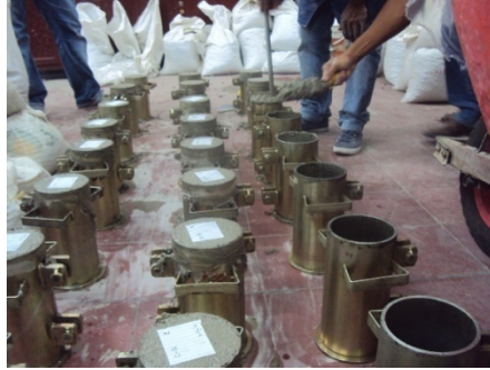
Fotografía 6. Vaciado de probetas cilíndricas M-R y M-C.
