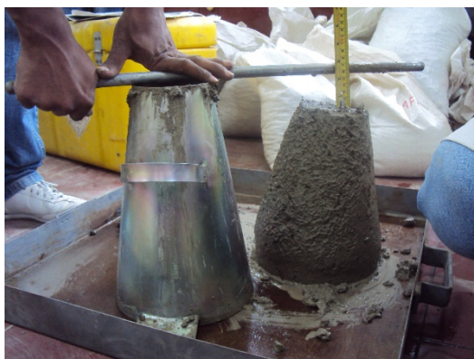
Fotografía 4. Mezcla M-R; ensayo de asentamiento.
