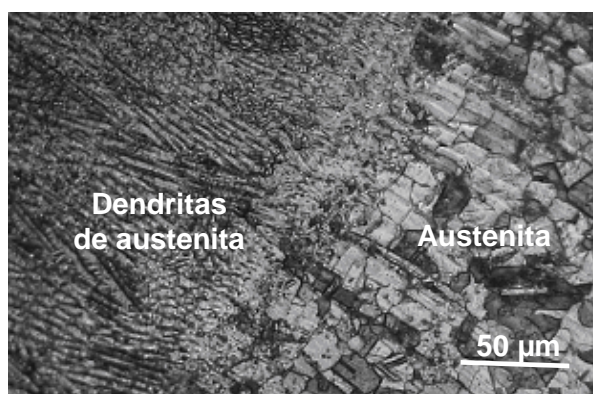
Figura 16. ZF y ZIT de la probeta P8-3
