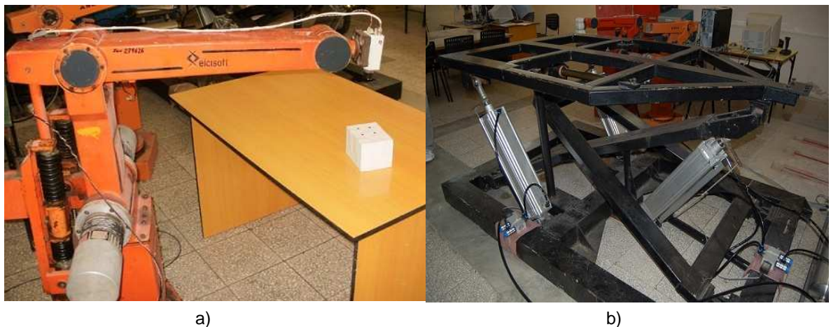
Figura 4. Plataforma experimental. a) Sistema servovisual, b) Plataforma electro-neumática.
