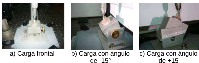
Fig. 5. Aplicación de cargas a las muestras
