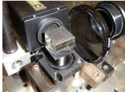
Fig. 6. Dispositivo experimental de Holografía Digital, Divisor de Haz ( Beam-splitter 90/10)
