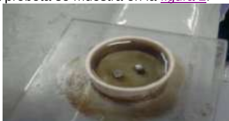
Fig. 2. Probeta para ensayo metalográfico
