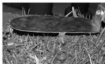
Figura 4. Electrodo en forma de suela de zapato.
