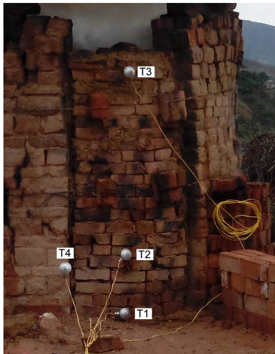
Figura 1. Termopares instalados por niveles en el horno
