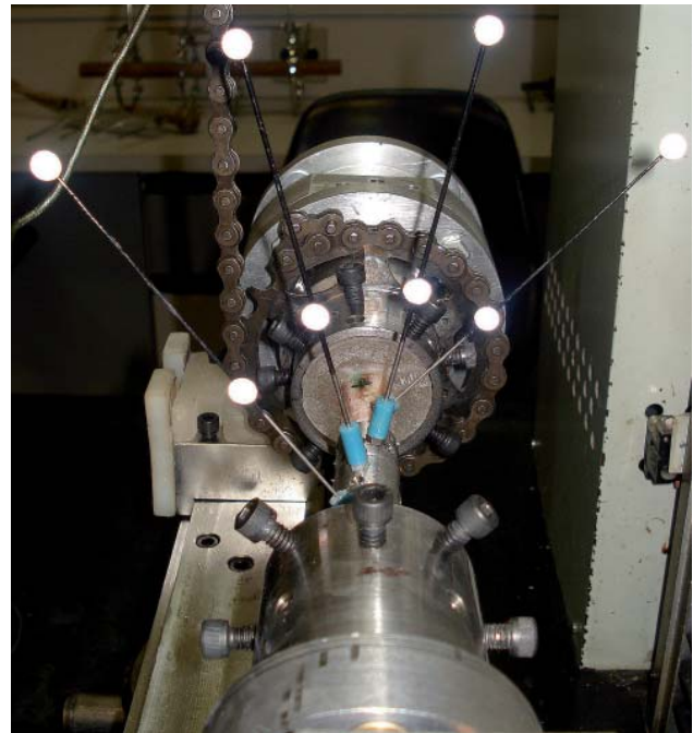
Figura 3. Imagem fotográfica do fêmur após posicionamento do corpo de prova no sistema da máquina de ensaios de torção, evidenciando os marcadores esféricos com diâmetro de cinco milímetros (um fixado no segmento proximal junto ao 'gap' de 40 mm, um marcador preso ao segmento distal próximo ao 'gap' e um fixado em cada módulo da prótese).
