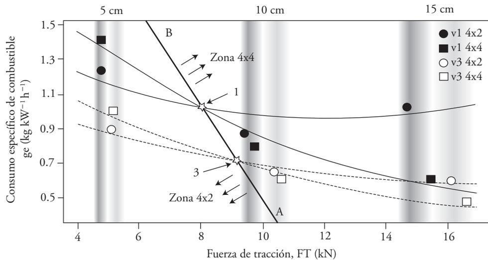
**Figura 5. Consumo específico de combustible en función de la carga aplicada.**
