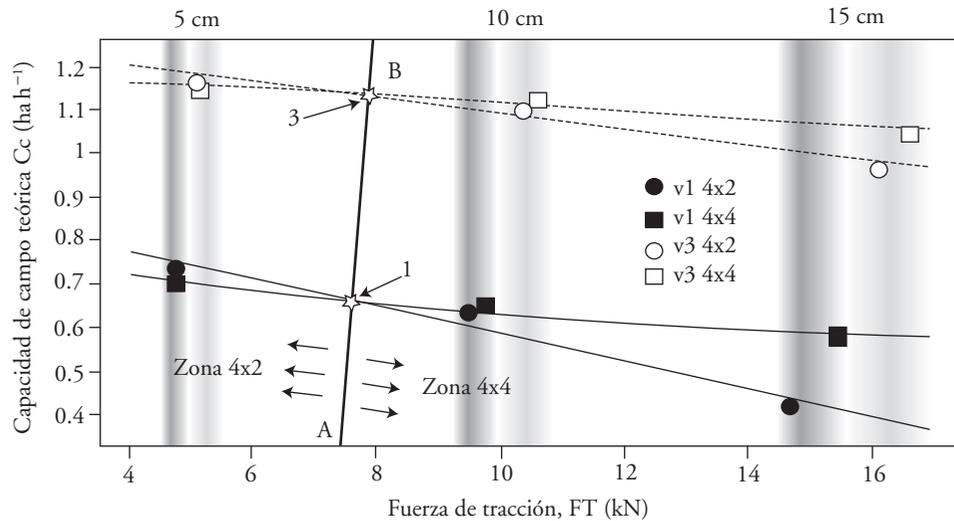
**Figura 6. Cambio en la capacidad de campo teórica en función de la carga aplicada.**
