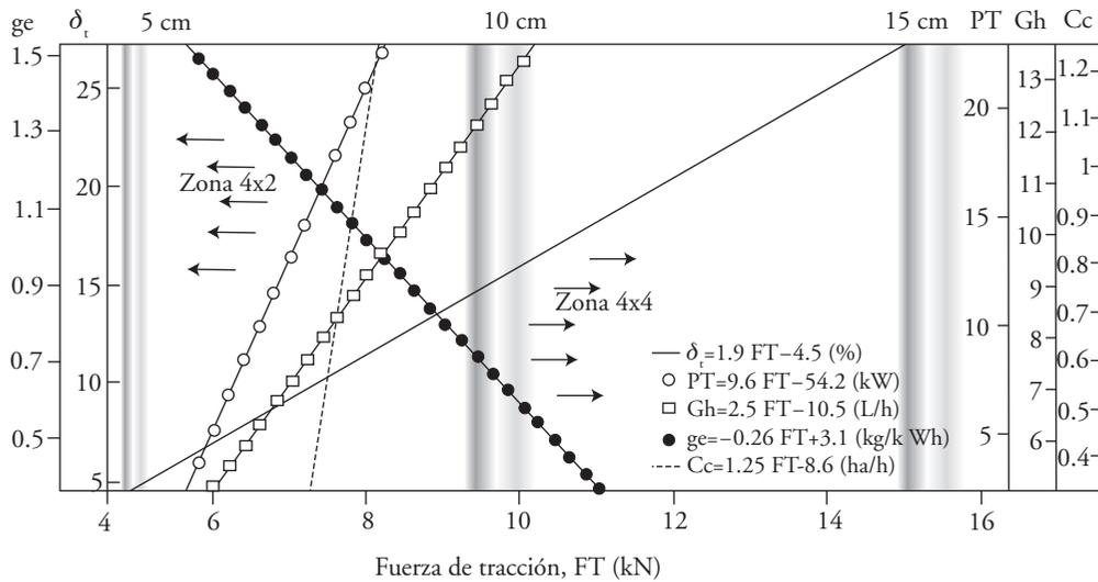
**Figura 7. Zonas de trabajo del tractor MF-592T en los esquemas de tracción 4x2 y 4x4.**
