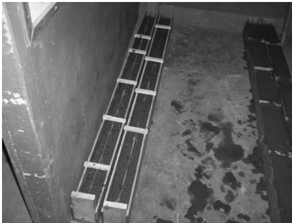
Figura 1. Moldagem das vigas.
