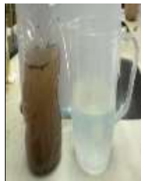
Fig. 5: Agua con agente coagulante y agua filtrada.
