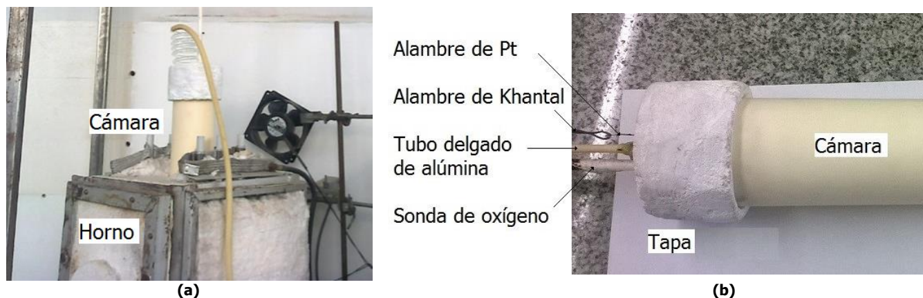
Fig. 4: Conjuntos de: cámara y horno (a) y dispositivos y cámara (b)
