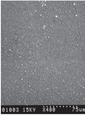
Figura 5. Fotografía por medio de MEB de la superficie de la resina TPH3, en su estado inicial, vista a 400X.
