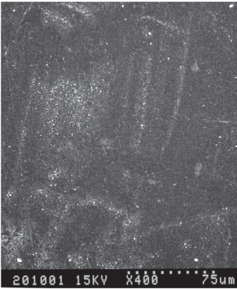
Figura 7. Fotografía por medio de MEB de la superficie de la resina Grandio, en su estado inicial, vista a 400X.
