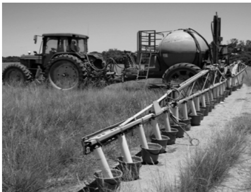
Figura 2 - Determinação de vazão individual das pontas de pulverização em pulverizador agrícola durante inspeção técnica. UFSM. Santa Maria, RS, 2008.
