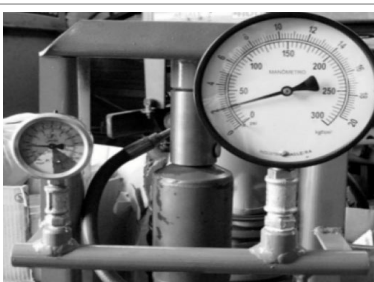
Figura 1 - Avaliação de manômetro de pulverizador agrícola (à esquerda) em bancada de teste com manômetro de precisão (à direita) durante inspeção técnica. UFSM. Santa Maria, RS, 2008.
