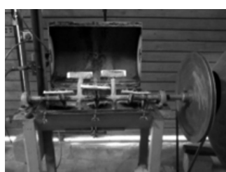
3. Proceso de encolado de la paja de cebada con uno de los adhesivos.
