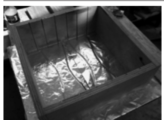
4. Proceso de encolado del rastrojo de cebada con uno de los adhesivos.
