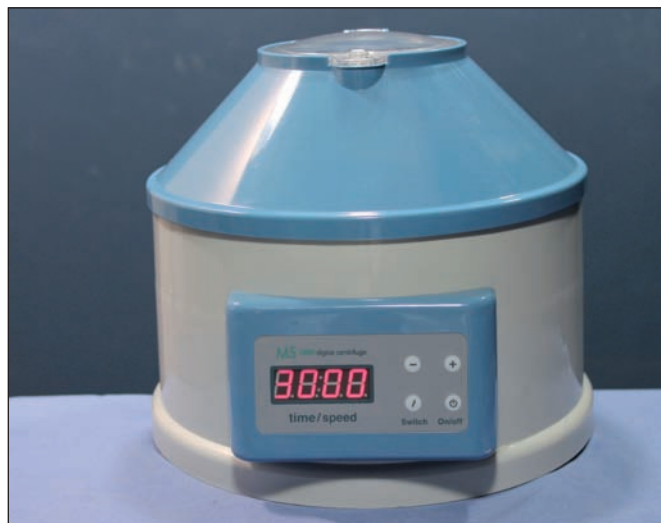
Fig. 6. Centrifugadora utilizada para preparar los microinjertos: 3 minutos a 3.000 rpm.
