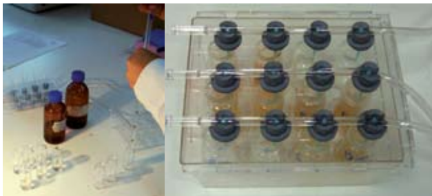
FIGURA 3: Preparación de las diluciones del extracto de maca en agua salina (Izquierda) y armado del sistema de oxigenación para Artemia franciscana (Derecha)
