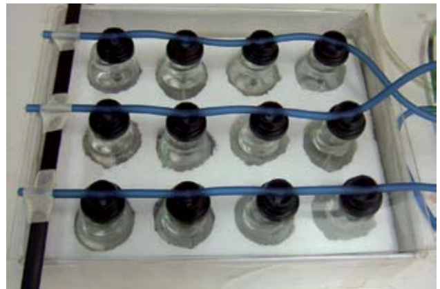
FIGURA 2: Sistema de oxigenación utilizado para realizar los ensayos con diferentes concentraciones de extracto de maca
