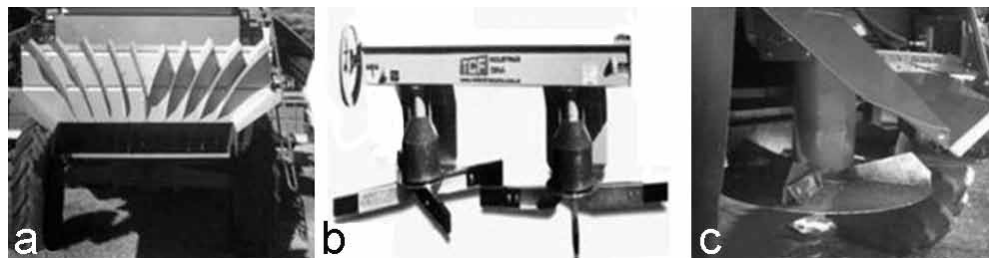
Figura 1. Desparramadores: a) desparramador con deflector. b) desparramador centrífugo de caucho. c) desparramador metálico.
