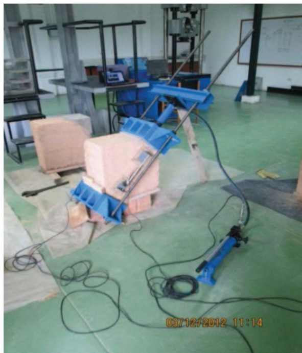
FIG. 4. Ensayo a Tracción en Muretes de Tapia Pisada [6] (Tomado Lab. Resistencia de materiales y sísmica UFPSO)
