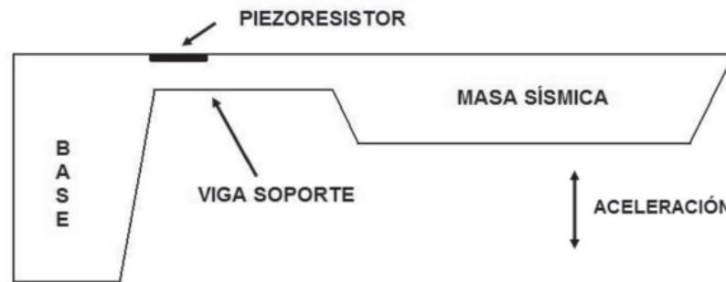
Figura 3. Sección transversal de un microacelerómetro piezoresistivo.
