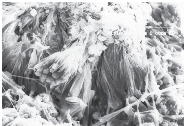
Figura 1: Micrografía por SEM a X6,000. Arcillas de tipo halloysitas. Piedra rosa del atrio de la Basílica Colegiata de Nuestra Señora de Guanajuato en Guanajuato, Gto., México.
