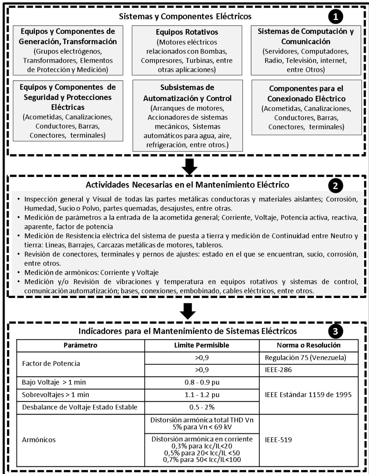
Figura 1. Esquema general de actividades y parámetros para el mantenimiento de sistemas eléctricos propuesto por los autores.
