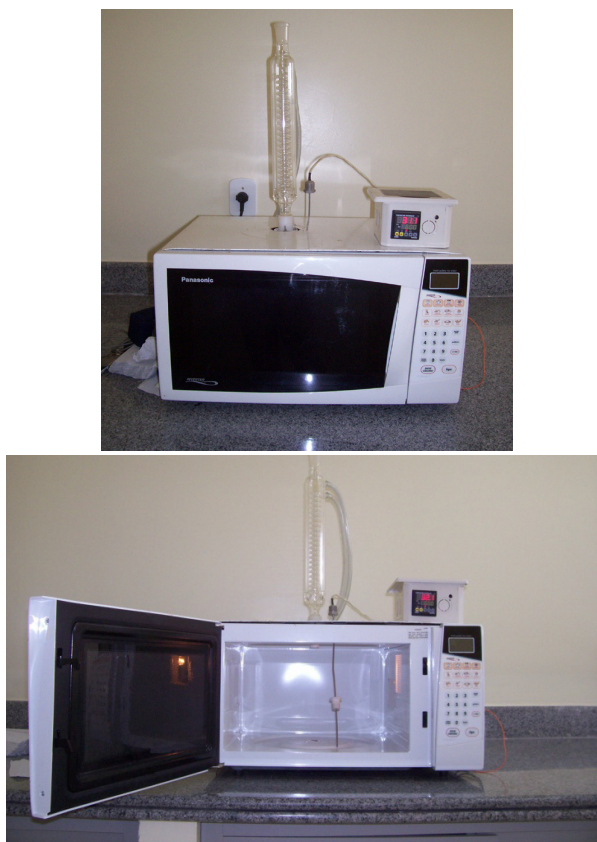
Figura 1 - (a) Forno de microondas doméstico adaptado para produção de biodiesel e (b) Parte interna do forno de microondas
