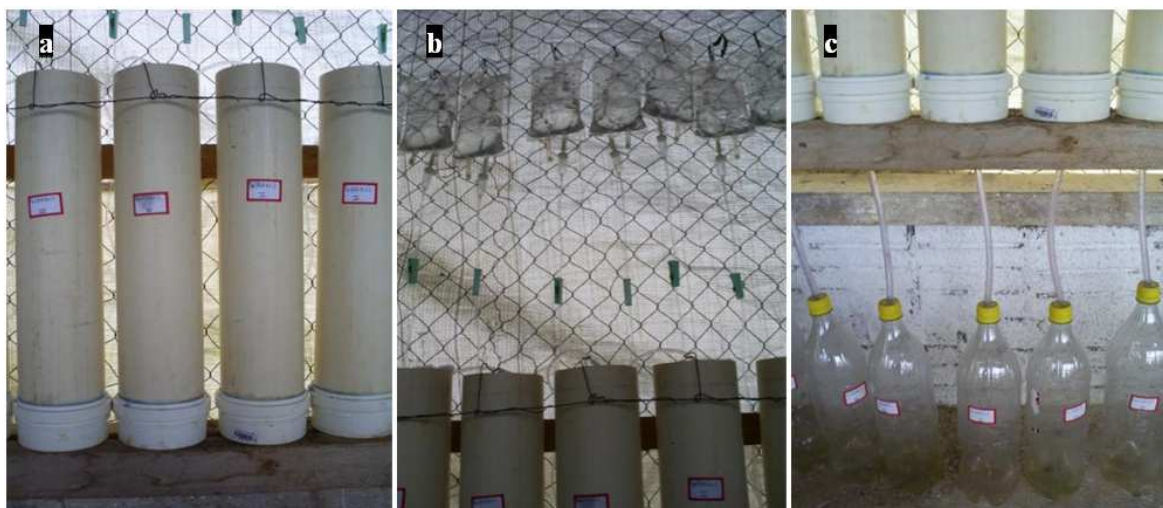
Figura 1. Colunas de solos (a); equipos para dosagem do gotejamento (b); frascos para coleta de lixiviado (c).
