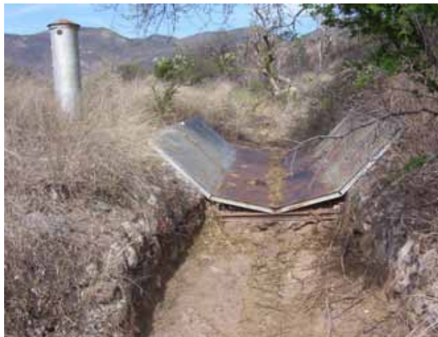
FIGURA 2. Estación de aforo con vertedor para flujo supercrítico tipo Santa Rita y limnógrafo FUESS en la cuenca La Cruz, Tabasco, Zacatecas.
