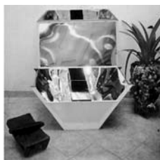
FIGURA 4. EL COMAL SOLAR TOLOKATSIN 2, EMPLEADO PARA FREIR ALIMENTOS
