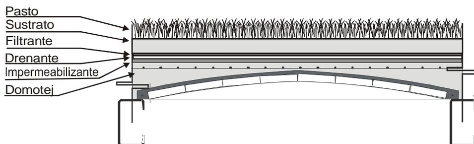
**Figura 12.** Corte esquemático del techo verde, adaptado a las condiciones de Tuxtla Gutiérrez, Chiapas, tomando como base de soporte al sistema Domotej.
