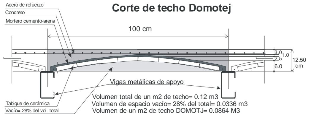
Figura 9. Corte de un metro cuadrado de techo DOMOTEJ, con el cálculo de volumen de concreto utilizado en un metro cuadrado
