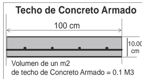
**Figura 4.** Corte esquemático de techo de concreto armado, con el cálculo del volumen de concreto en un m2 de techo.
