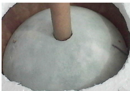
Figura 4- Parte da Maquete do reservatório: calota inferior.
