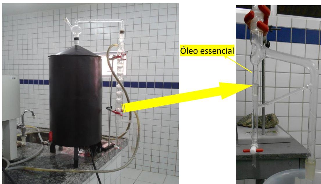
Figura 03: Extrator de óleo construído em funcionamento. Fonte: Maia Silva (2013)
