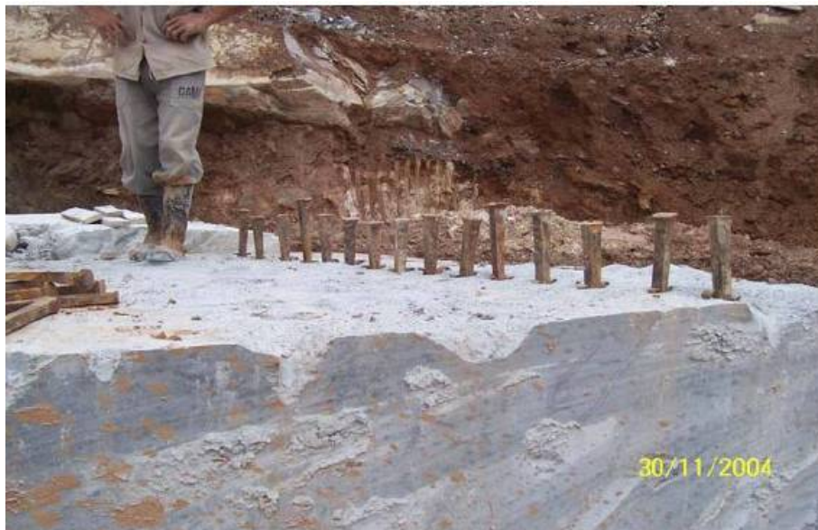
Figura 5 – Furos com cunhas metálicas (Almeida, 2006).
