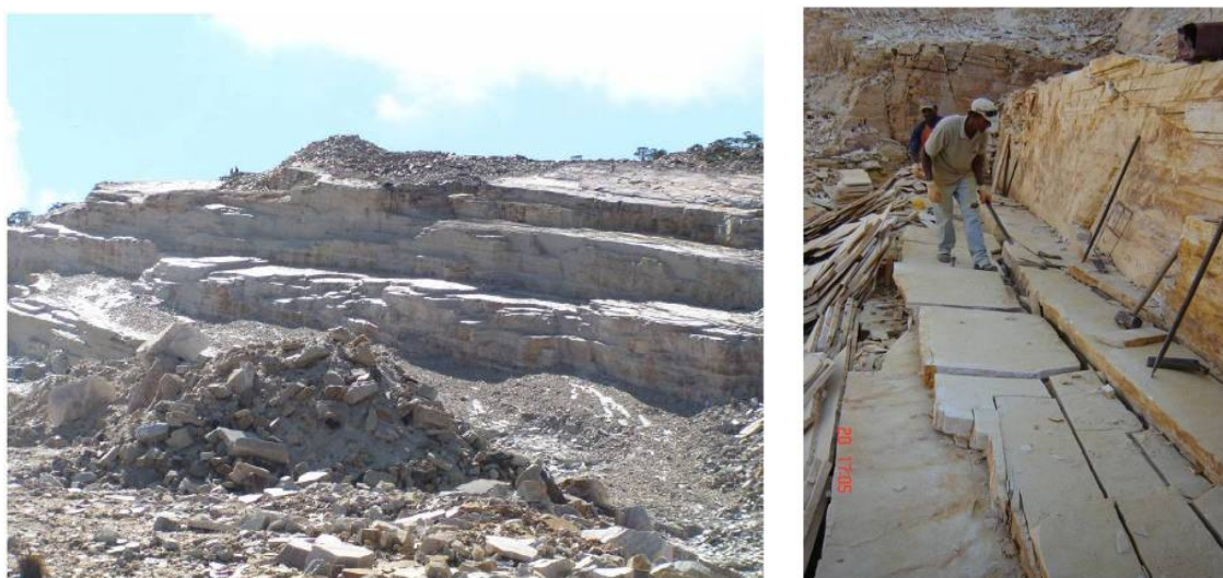
Figura 1 - Frente de lavra e remoção das placas de quartzito foliado – Alpinópolis / MG (Valadão et al, 2010).
