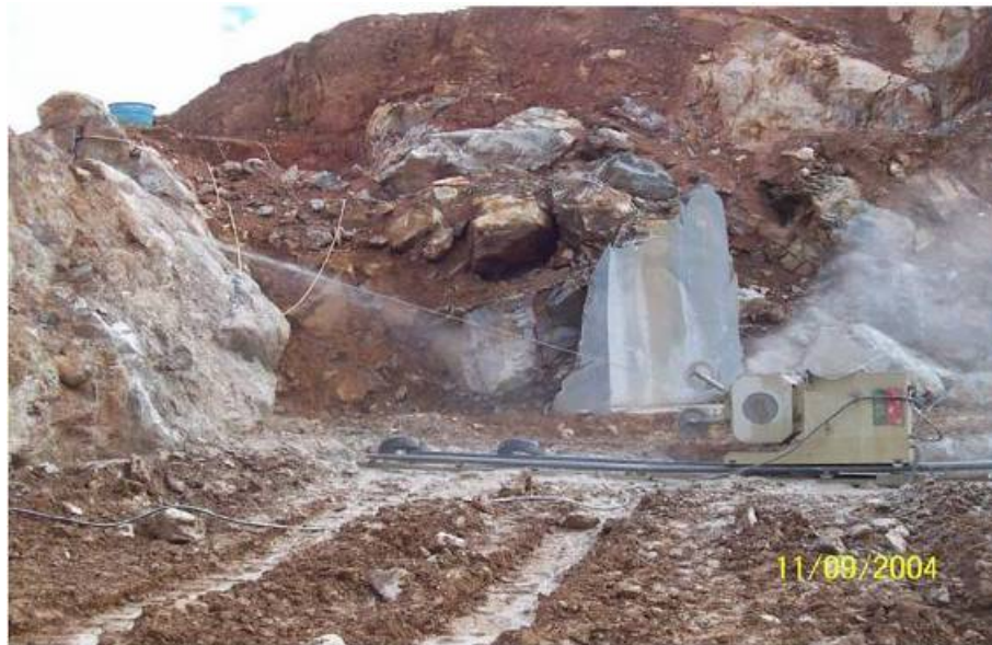
Figura 4 – Corte vertical com fio diamantado (Almeida, 2006).
