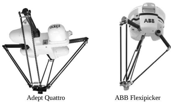
Figura 6. Robots Delta para aplicación industrial. Fuente: [20].
