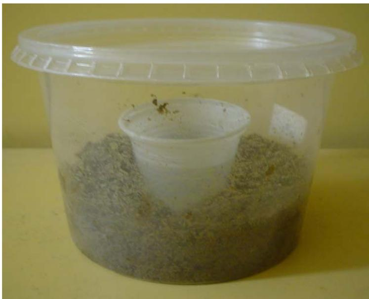
**Figura 1** - Unidade experimental para mediação de respiração microbiana: solo + material orgânico, frasco contendo NaOH e recipiente hermeticamente fechado.
