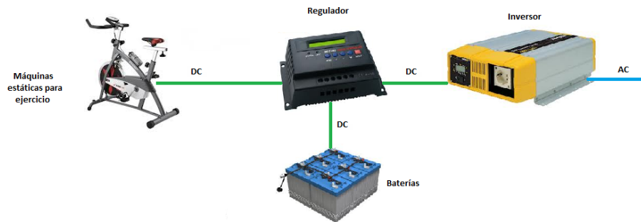
Figura 2. Sistema de generación distribuida en base a bicicletas estáticas aislado a la red [14].
