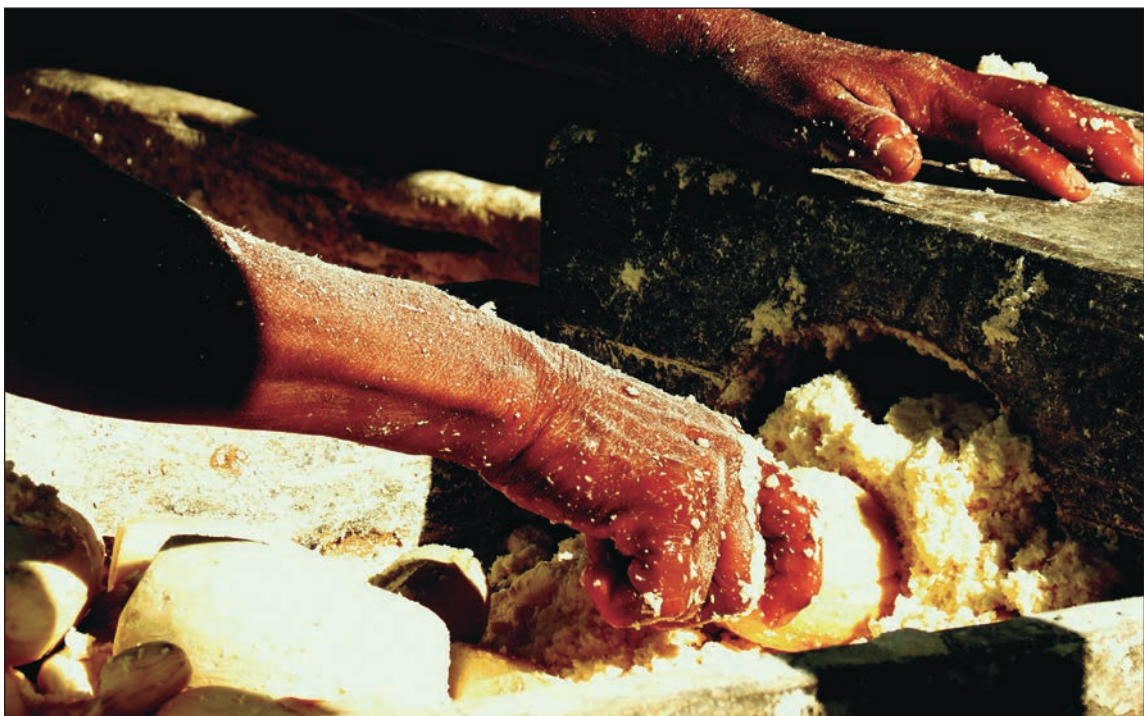
Molienda de la yuca. Este proceso es realizado por un molino rallador denominado “cigüeña”, el cual es impulsado por un motor de gasolina. Esto da como resultado una masa húmeda que se deja reposar por una noche para que se fermente y se pueda pasar al prensado.
