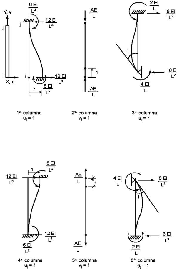
Fig. 2.9 - Fuerzas correspondientes a cada columna de la matriz de rigidez de un elemento vertical de pórtico plano.
