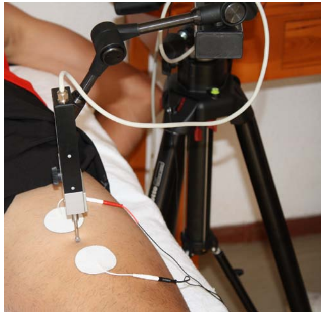
Figura 2. Colocación del los electrodos y el sensor de desplazamiento.
