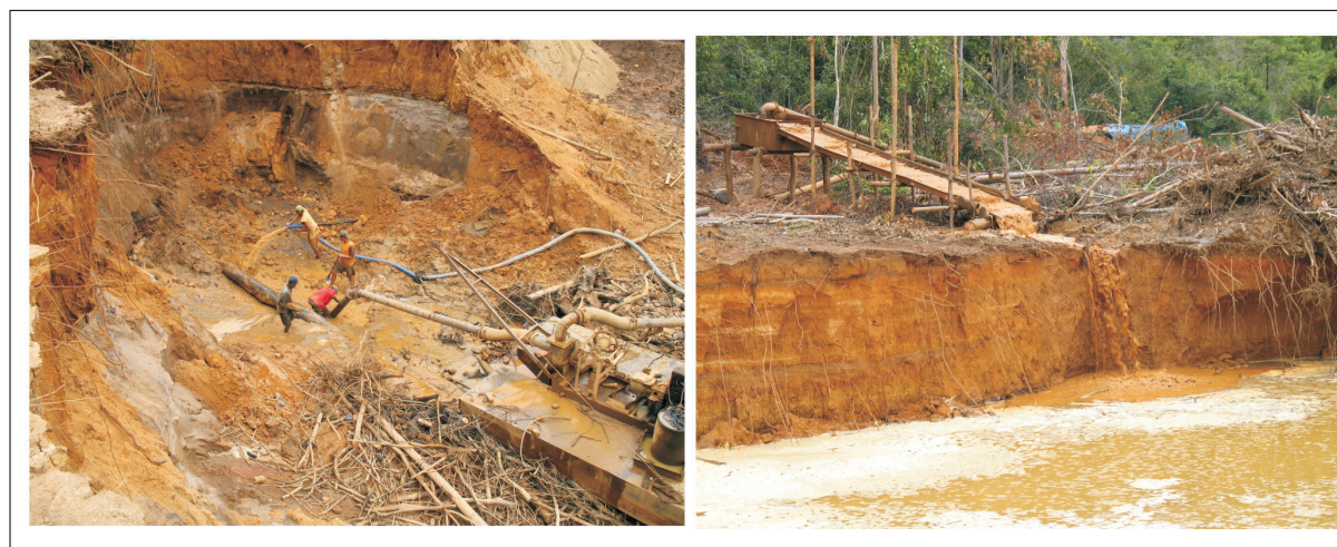
Figura 2 - Processos de desmonte hidráulico do minério e bombeamento (esquerda) deste aos sluices para concentração do ouro em carpetes (direita). Notar descarte do rejeito diretamente no leito do rio.
